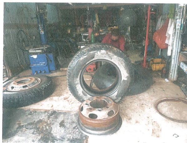
รูปแสดงการซ่อมชุดล้อรถหกล้อบรรทุกน้ำ
